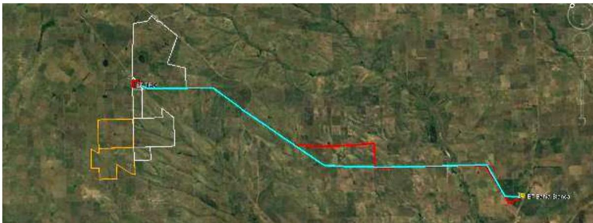
Figura 4 – Se observa la traza actual de la LAT 132 kV (línea celeste) y los dos tramos nuevos por donde se propone pasar la traza (líneas rojas) para reducir el tendido a campo travesía.
