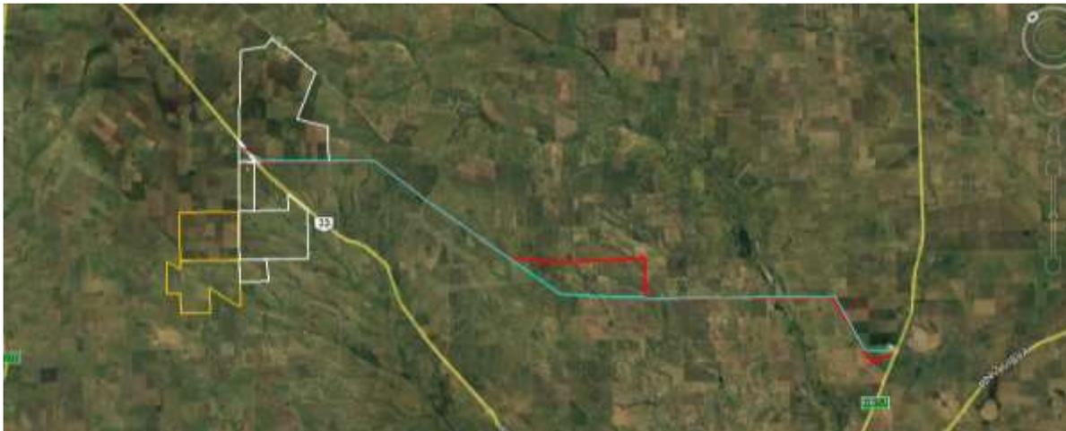
En la imagen se muestra la ubicación de la ET TPO y la traza ajustada de la LAT 132 kV. Se observan los dos tramos que serán ajustados (línea roja) para reducir el tendido a campo traviesa.
